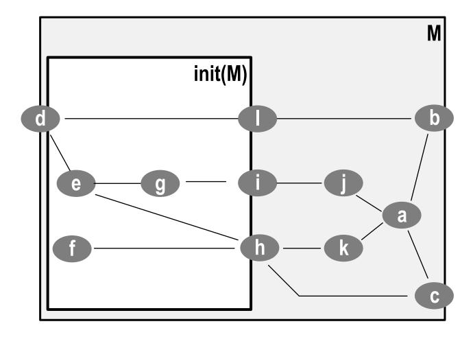
module M a cut an initial module a final module M = init(M) • final(M)
